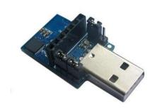
A-USB-TTL [E15-USB-T2]は成都 EBYTE 電子技術有限公司が開発・ 生産した UART (TTL レベル) インターフェイスを持つ無線モジュールで す。このモジュールは USB から UART への変換を可能にすることによ り、操作の簡素化を実現しています。
